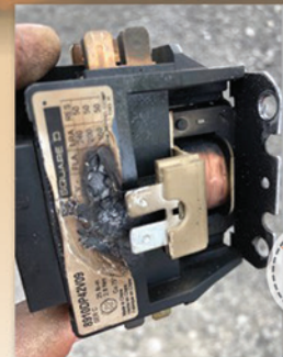
Défaut soudain sur contacteur de moteur de "mixer RTM".
