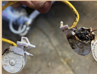
Un connecteur de lumière lourdement endommagé et à risque.
